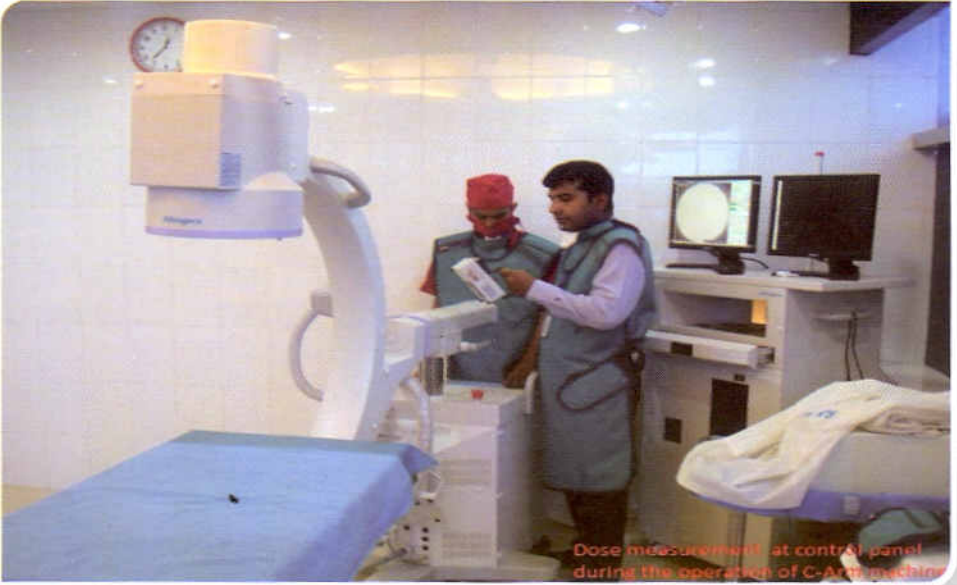
পরমাণু শক্তি নিয়ন্ত্রণ কর্তৃপক্ষের কর্মকর্তা কর্তৃক সি-আর্ম মেশিন পরিচালনাকালে কন্ট্রোল প্যানেলের ডোজ পরিমাপন
